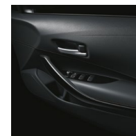
ドアトリムガーニッシュ(スモークシルバーマトリック塗装+ピアノブラック加飾)+合成皮革巻きドアアームレスト表皮(ノフトタイプベージュステッチ付)
