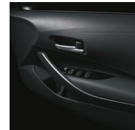
ドアトリムガーニッシュ(シルバー塗装)+ファブリックドアームレスト表皮
