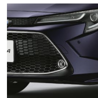
フロントロアグリル(フレーム部:メッキ+ブラック艶有り塗装、メッシュ部:ブラック艶有り塗装)
