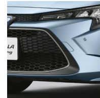
フロントロアグリル(フレーム部:グレーメタリック塗装+ブラック、メッシュ部:ブラック)
