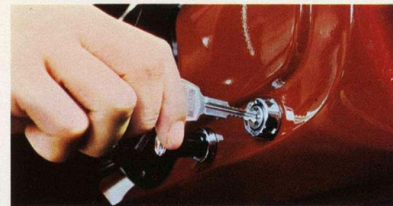
両ざし式キー。ドアもエンジンもバックドアもこれ1本でOK。
