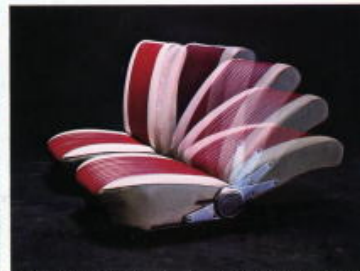
操作はノブひとつ…シート両サイドのノブを引く だけでお好みの角度がえられます。またシート下 方のノブ操作で前後に120ミリも移動できます。
