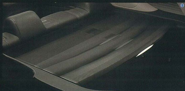
①スライド式トノボード(トノカバー内蔵)/トノボードのスライド量は270mm。リヤ席からの荷物の出し入れが可能です。内蔵されたトノカバーでラゲージルームを覆うこともできます。
