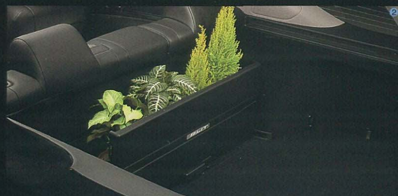
①スライド式トノボード(トノカバー内蔵)/トノボードのスライド量は270mm。リヤ席からの荷物の出し入れが可能です。内蔵されたトノカバーでラゲージルームを覆うこともできます。
