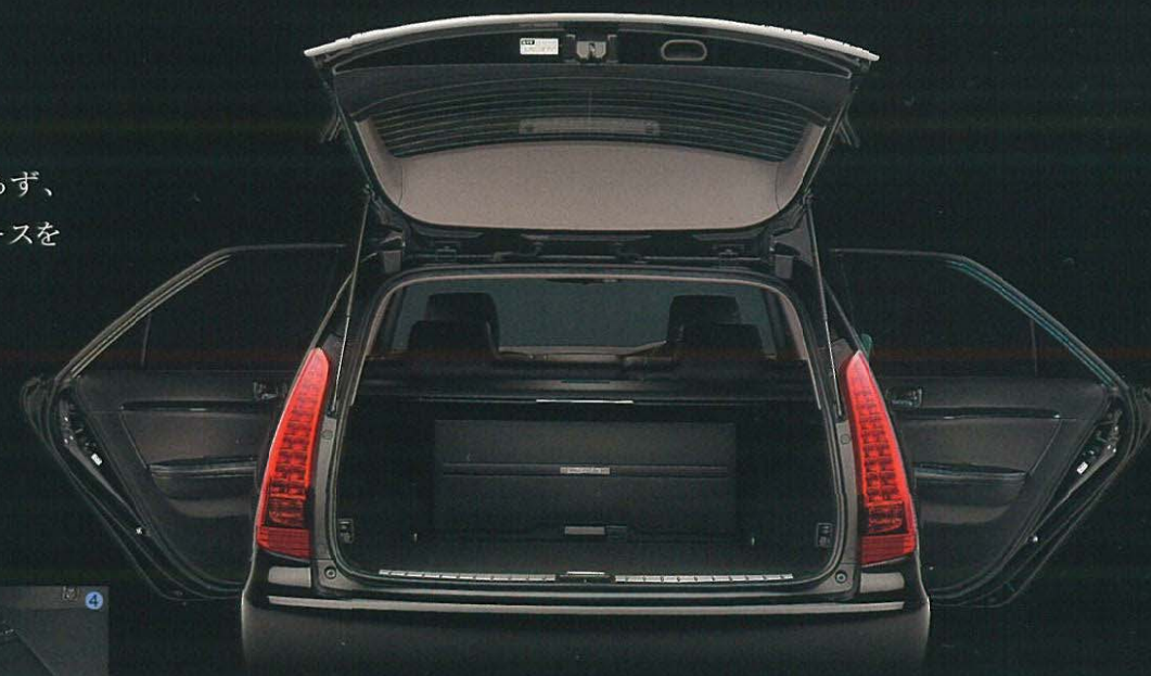
①デッキボード(オープン時)/デッキボードには折りかえしを設けたことで、後方部だけの開閉も可能です。デッキアンダートレイへの荷物の出し入れを容易にするデッキボードのフックも設定。
