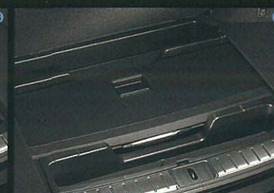
①デッキボード(オープン時)/デッキボードには折りかえしを設けたことで、後方部だけの開閉も可能です。デッキアンダートレイへの荷物の出し入れを容易にするデッキボードのフックも設定。
