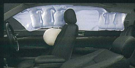
SRSサイドエアバッグ(運転席・助手席) & SRSカーテンシールドエアバッグ(前後席)
