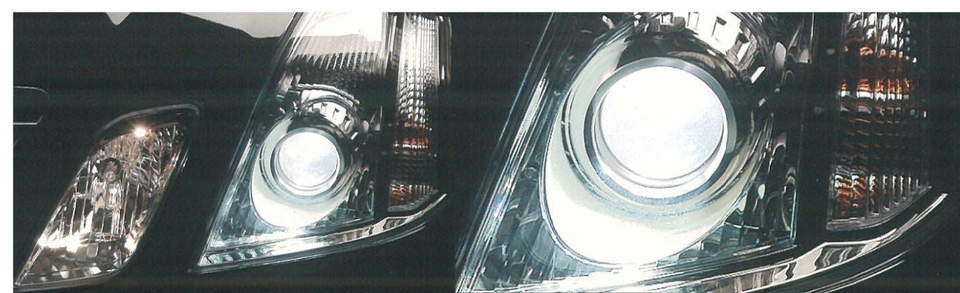
プロジェクター式ディスチャージヘッドランプ
