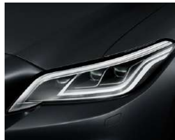
3眼LEDヘッドランプ+LEDクリアランスランプ (デイルイト機能/おもてなし照明付) +ヘッドランプクリーナー
