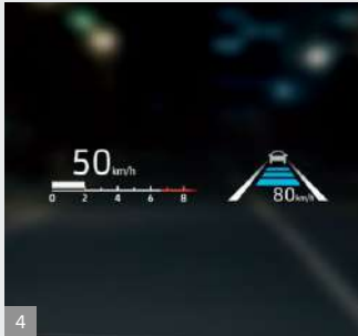
4 運転に必要な情報をウインドシールドガラスの視野内に投影。 カラーヘッドアップディスプレイ
