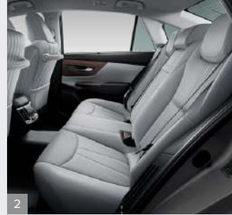
左右席はシートリクライニングが無段階調整可能。 リヤパワーシート(40/20/40分割リクライニング)
