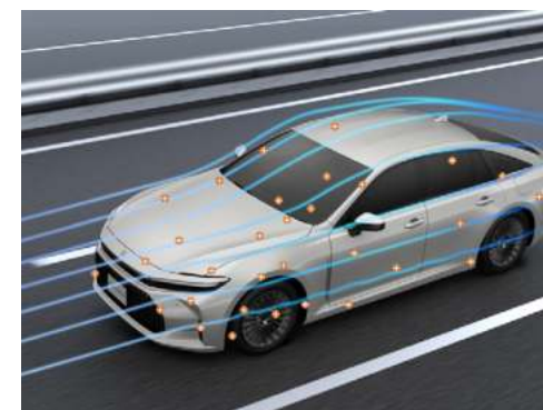
機能あり状態のイメージ: 走行によるタイヤ周りの帯電を低減することで、タイヤ周りの流れの乱れを低減
