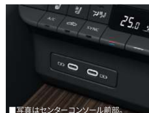
■写真はセンターコンソール前部。 Ⓔ充電用USB端子 (Type-C/センターコンソール前部2個・LED照明付) ①充電用USB端子 (Type-C/センターコンソール後部2個・LED照明付)
