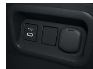
Ⓔ通信/充電用USB端子 (Type-C/センターコンソールボックス内側1個) Ⓔアクセサリソケット (DC12V・120W/センターコンソールボックス内側1個)
