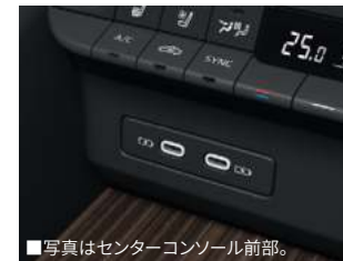
■写真はセンターコンソール前部。 Ⓔ 充電用USB端子 (Type-C/センターコンソール前部2個・LED照明付) Ⓕ 充電用USB端子 (Type-C/センターコンソール後部2個・LED照明付)
