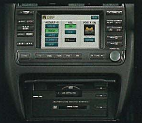
<クラウン・スーパーライブサウンドシステムEMV仕様> MD/CDプレーヤー&カセット・AM/FMマルチ電子チューナーラジオ+7スピーカー
