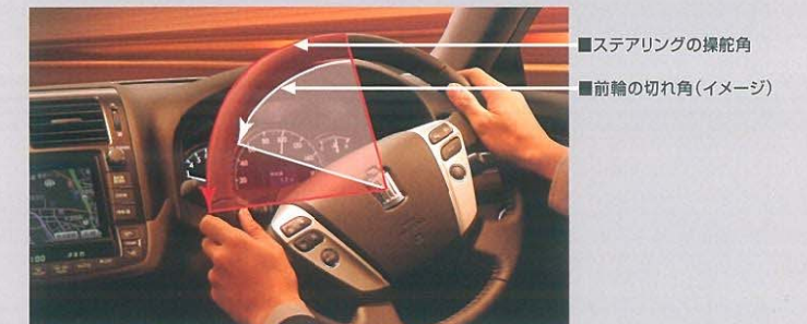
高速走行時は、ステアリング操作に対して前輪の切れ角を小さくし、安定したハンドリングを実現する。
