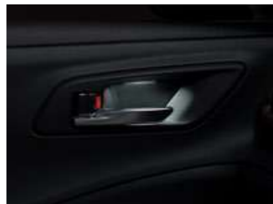
イルミネーテッドエントリーシステム (フロント・リヤインサイドドアハンドルLED照明)
