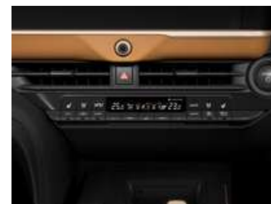
3席独立温度コントロールフルオート エアコン (オールオート機能付・S-FLOW：1席/前席集中モード付)
