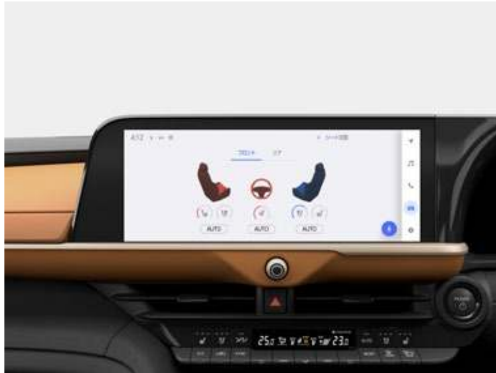
シートヒーター操作画面
