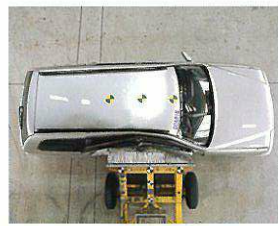
側面衝突実験(55km/h、写真は実験用試作車です。)
