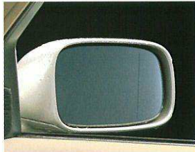
ヒーター付レインクリアリングミラー(ワイドビュー・ブルーミラー)
