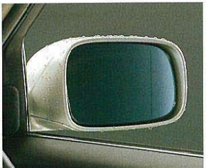
ヒーター付レインクリアリングミラー(ワイドビュー・プルミラー)
