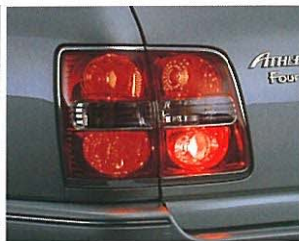
リヤフォグランプ ※リヤフォグランプを装着した場合、テールランプの点灯状態が変わります。
