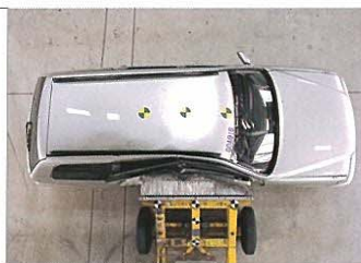
側面衝突実験 (55km/h、写真は実験用試作車です)
