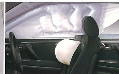
SRSサイドエアバッグ&SRSカーテンシールドエアバッグ (運転席・助手席)
