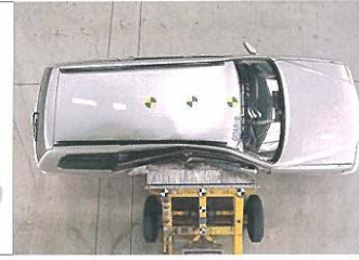
側面衝突実験 (55km/h、写真は実験用試作車で)
