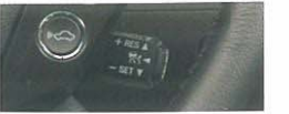
クルーズコントロールスイッチ 車間距離切替えスイッチ
