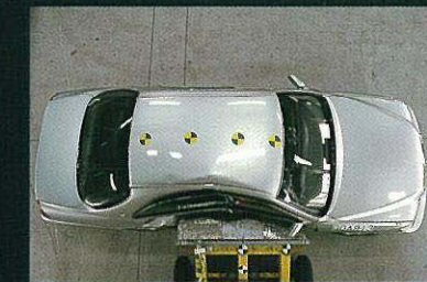
側面衝突実験 (55km/h、写真は実験用試作車です。)
