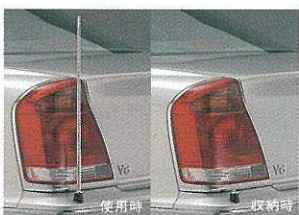
フェンダーランプ (電動リモコン伸縮式リヤ)
