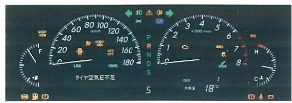
①通常走行時:車速表示 ②交差点案内:交差点までの残距離と交差点の形状(音声)「300m先〇〇町を左方向です」 ③交差点案内:交差点までの残距離と交差点の形状(音声)「まもなく左方向です」 ④交差点を曲がった後に通常の車速表示にもどる
