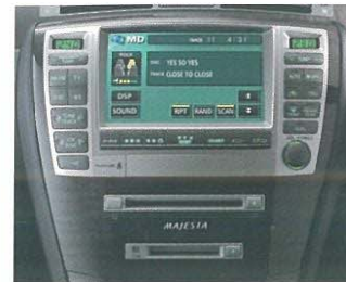
クラウン・スーパーライブサウンドシステム ＜G-BOOK対応高精細DVDボイスナビゲーション付EMV＞ TV・AM/FMマルチ電子チューナーラジオ+インダッシュ6連奏DVDオートチェンジャー+MD+8スピーカー
