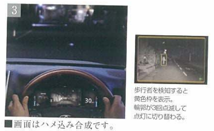
歩行者を検知すると黄色枠を表示。輪郭が3回点滅して点灯に切り替わる。 ■画面はハメ込み合成です。
