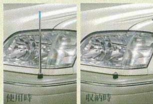
フェンダーランプ(電動リモコン伸縮式・フロントオート)
