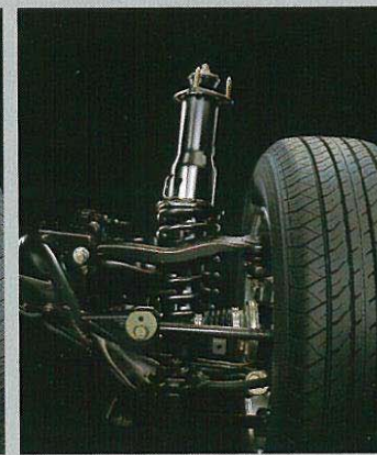
4輪ダブルウィッシュボーンサスペンション(H ∞ -TEMS仕様-フロント)
