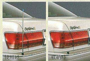
フェンダーランプ(電動リモコン伸縮式・リアオート)
