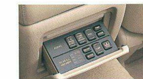
リヤコントローラー (エアコン、オーディオ、電動リヤサンシェード)
