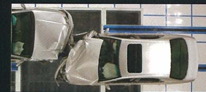
Car to Car SUV前面衝突実験 (50km/h 写真は実験用の試作車です)
