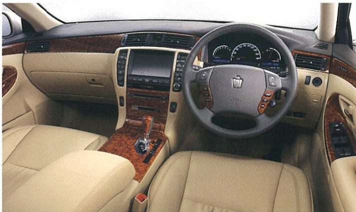
Photo:3.0ロイヤルサルーンGの運転席。内装色はアイボリー。レーダークルーズコントロール、音声ガイダンス機能付カラーバックガイドモニター&クリアランスソナー、ナイトビュー、クラウンマークレピソニック®プレミアムサウンドシステム<G-BOOK対応高解像度DVDボイスナビゲーション付EMV>、マイコン制御チルト&スライド電動ムーンルーフはメーカーオプション。本革シートとシートヒーターはセットでメーカーオプション。
