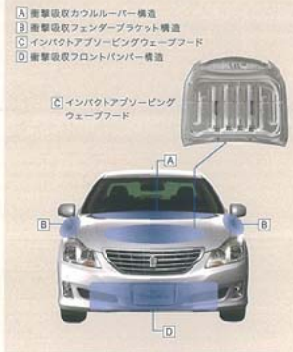
歩行者傷害軽減に配慮したボディ構造説明イラスト
