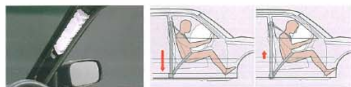
頭部衝撃緩和構造インテリア *4 衝突の形態によっては、乗員が二次的に客室と衝突する場合も考えられます。そこで、衝撃を緩和できるビニールカーニッシュや天井構造を採用しました。 プリテンショナー&フォースリミッター付シートベルト *5 プリテンショナー機構は、前方からの強い衝撃を感知するとシートベルトを巻き取って拘束効果を高め、フォースリミッター機構はシートベルトによる乗員の胸部への荷重を緩和します。
