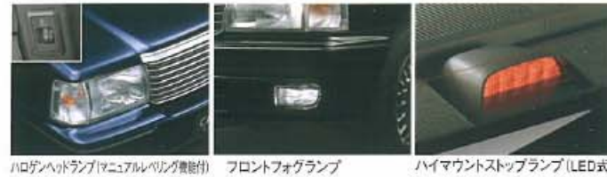
ハロゲンヘッドランプ(マニュアルレベリング機能付) フロントフォグランプ ハイマウントストップランプ(LED式)
