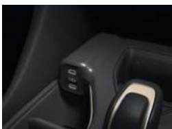
①充電用USB端子 (Type-C/センターコンソール前部2個・LED照明付)
