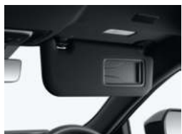
⑥サンバイザー (バニティミラー・LED天井照明・チケットホルダー付)
