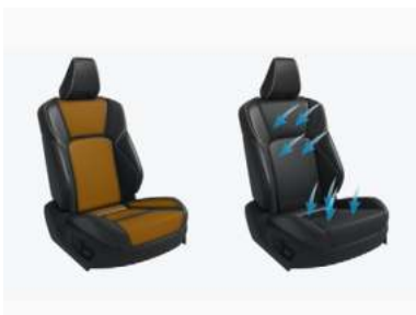
(左)オレンジは、ヒーター加温箇所 (右)シートベンチレーション作動イメージ
