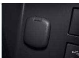
㉓アクセサリソケット (DC12V・120W/センターコンソールボックス内側1個)
