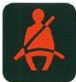
運転席シートベルト 非着用警告灯
