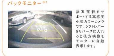
後退運転をサポートする高感度 小型カラーカメラ です。シフトレバー をリバースに入れる と後方映像を モニターに自動 表示します。
