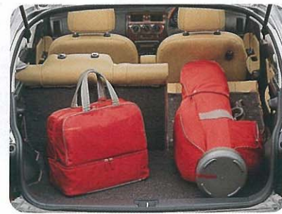
リヤシート片側前倒し ロングサイズのものリヤシートを倒して収納。3人乗って長い荷物も積める。とても便利な機能です。
