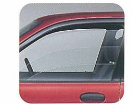
パワーウィンドウ (運転席ワンタッチ式・挟み込み 防止機能付) ウィンドウを閉める時、窓枠とガラス の間に異物を感知すると、ウィ ンドウが一止し、その後自動的に開く、 乗員の安全を考えたパワーウィンドウです。
