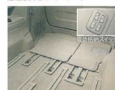
6:4分割・電動床下格納機能付サードシート
