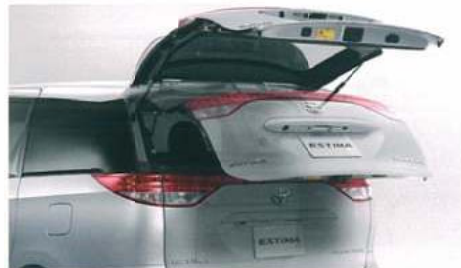
パワーバックドア
