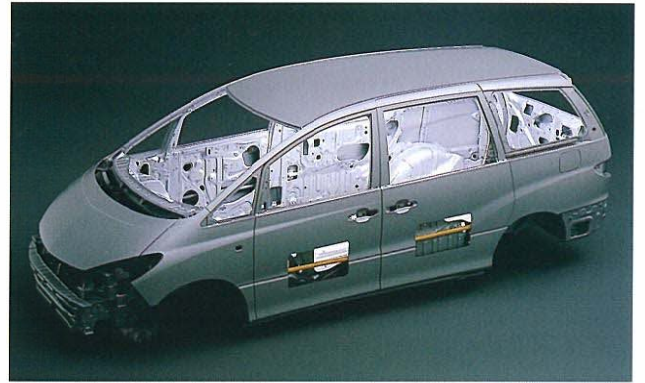
衝撃吸収ボディ&高強度キャビン“GOA” ●サイドエアームは機能説明のために着色したものです。
