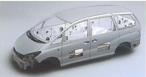
衝撃吸収ボディ&高強度キャビン“GOA” ●サイドドアビームは機能説明のために着色したものです。
