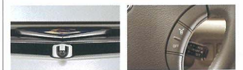
ブラインドコーナーモニターカメラ部 (フロントグリル) ブラインドコーナーモニタースイッチ (フロントグリル) ●アエラスのブラインドコーナーモニタースイッチはインパネに設置されます。
