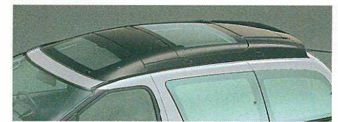
ジョイフルキャノピー キャビンに開放感を生み出す高いルーフ(室内高:ツインムーンルーフ+65mm)。フロントルーフガラスはチルトアップ式、リヤルーフは電動アウターライド式です。
