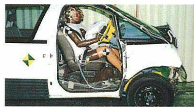
50km/hフルラップ衝突実験（写真は実験用の試作車です）
