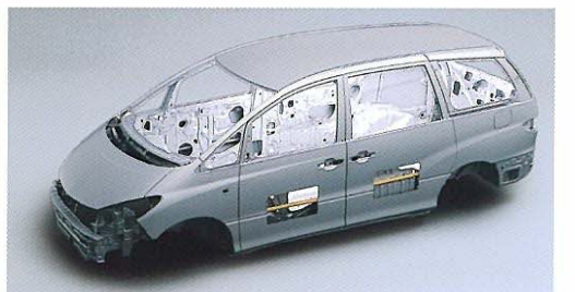
衝撃吸収ボディ&高強度キャビン“GOA” ●サイドドアビームは機能説明のために着色したものです。
