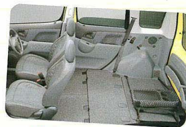
リヤシート床下収納状態
