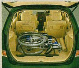
手動車いす用固定装置(ガードマット付) (A・Bタイプ共通) 車いすを固定装置(ベルト)で固定し ます。
