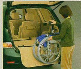
手動車いす用収納装置(電動式) (Bタイプのみ) 車いすに掛けた吊りベルトを電動で 巻き上げます。
