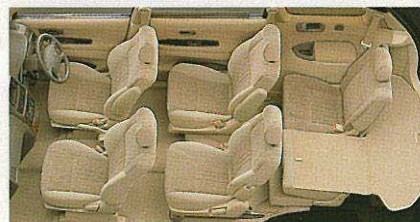
5名乗車+サードシート片側可倒式ラゲージルーム
