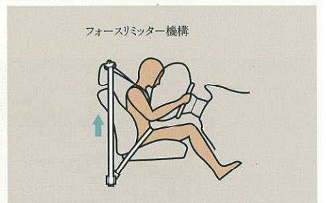
前席プリテンショナー&フォースリミッター付シートベルト ※プリテンショナー機構は衝突時の衝撃が弱い場合は作動しません。
