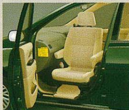
助手席リフトアップシート (A・Bタイプ共通) 助手席シートが回転し、車外に大きく スライドダウン。乗り降りを優しくサポ ートします。
