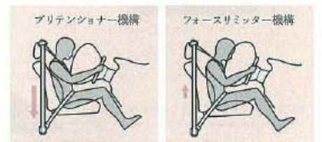
プリテンショナー機構 フォースリミッター機構 プリテンショナー&フォースリミッター付フロントシートベルト *プリテンショナー機構は衝突時の衝撃が弱い場合は作動しません。
