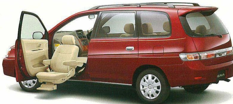
Photo:GAIA 2WD 助手席リフトアップシート車“Aタイプ” “Lパッケージ”6人乗り (TA-ACM10G-VTSELPYP) ボディカラーはレッドマイカ<3M8>。
