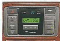
フロントオートエアコン&デジタル表示ヒーターコントロールパネル
