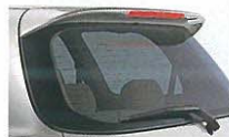
リヤルーフスポイラー&LED式ハイマウントストップランプ
