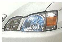
デイスチャージヘッドランプ(コービーム・レベリング機能付)
