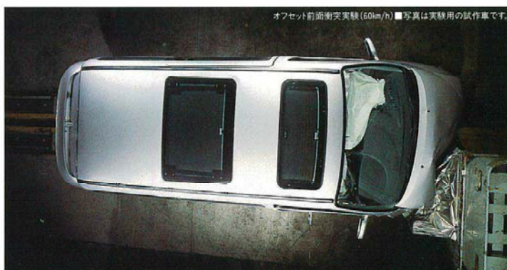
オフセット前面衝突実験 (60km/h) ■写真は実験用の試作車です。
