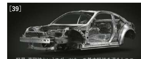
軽量・高剛性というスポーツカーの基本特性を満たしつつ、全方向からの衝突エネルギーを効率的に吸収できるボディ構造を追求しています。
