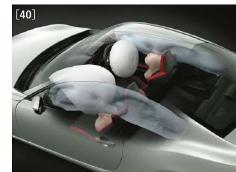
軽量・高剛性というスポーツカーの基本特性を満たしつつ、全方向からの衝突エネルギーを効率的に吸収できるボディ構造を追求しています。
