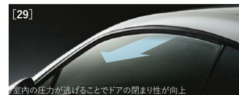
室内の圧力が逃げることでドアの閉まり性が向上
