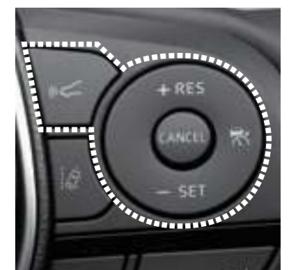
レーダークルーズコントロール/ 車間距離切替スイッチ
