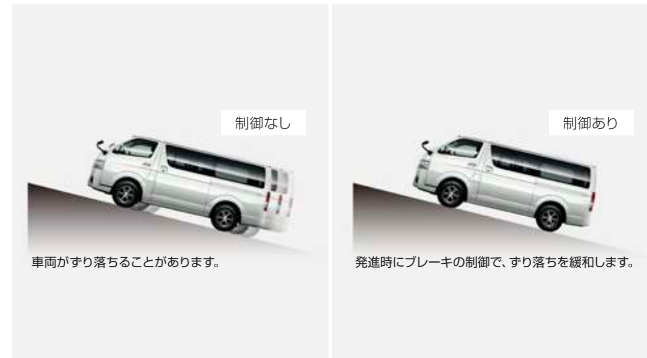
ヒルスタートアシストコントロール作動イメージ図
