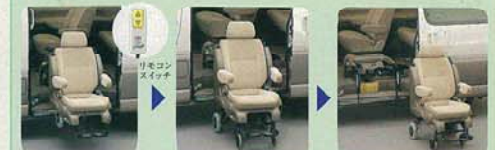
リモコン操作でシートが車外にスライドダウンし、自動的に車輪が出ます。車輪が接触すると、シートは分離可能になります。サイドリフトアップシートはそのまま合体式の車いすとしてご利用いただけます。(ハンドブレーキ付)
