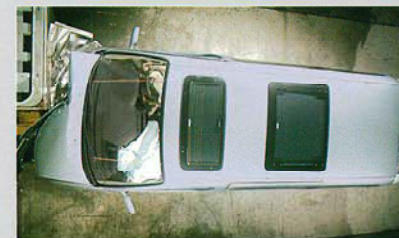
①フロント側面衝突試験(60km/h) ●写真は実車試験用試作車です。
