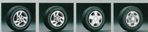
215/65R15 96H (15×6J)アルミホイール [2WD用] 215/70R15 98S (15×6J)アルミホイール (4WD用) 205/70R15 95H (15×6J)対スチール製7L+7Hタイプ [2WD用] 215/70R15 98S (15×6J)スチールホイール (4WD用)
