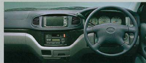
Photo: 2WD 3.0 インタークーラー付ディーゼルトボ ツーリングハイエース“Vパッケージ”の計器盤と室内。内装色はブルーイッシュグレー。DVDボイスナビゲーション付ワイドマルチAVステーション、マルチディスプレイシートはメーカーオプション。
