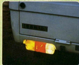
●後続車に注意をうながすリヤ・コンビネーションランプ(内側はターンシグナル用、外側はストップランプ、後部バック用)
