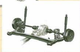
トーションビーム式コイルスプリングサスペンション (リヤ) (イラストは4WD用)
