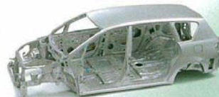
衝撃吸収ボディ & 高強度キャビン“GOA” ■写真は中台アビームは説明のために着色したものです。
