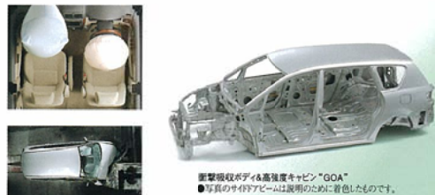
オフセット前面衝突実験 (64km/h)写真は実験員の試着時です。
