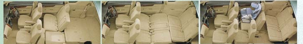
3人~4人乗車+荷室 (6:4分割可倒式セカンドシート) セカンドシートを折りたたんで長さのある荷物も楽に収納できます。 セカンドシートフルフラット シートを倒して、ゆったりとしたリラックス空間が楽しめます。 セカンドシート6:4分割独立スライド チェイルドシートをセカンドシートに装着したままでも、サードシートへの乗り降りが入ります。
