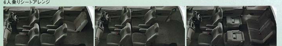
5人乗車+荷室 サードシートは5:5分割で収納できます。セカンドシートからサードシートへのウォークスルーが可能です。 4人乗車+荷室 ワンタッチでサードシートを収納。フロントシートからリヤシートへのウォークスルーが可能です。 4人乗車+シートバックテーブル(セカンドシート) リンゲルームのような雰囲気で作れるシートテーブルは、食事の際などに便利です。 *サイズによっては入らない場合がありますので、詳しくは販売店におたずねください。●通常以外のシートアレンジには走行できない場合やご注意ください。必ず取扱書をご覧ください。
