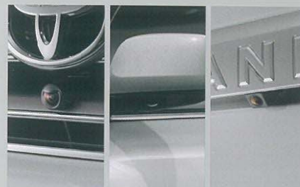
ワイドビューフロント&サイドモニター・音声ガイダンス機能付バックガイドモニター
