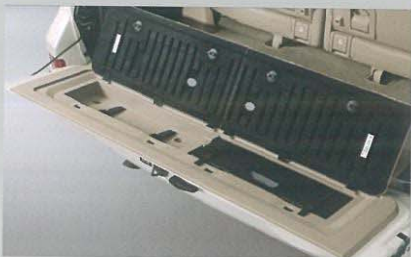
テールゲート収納スペース ●右側スペースには、ツールボックスが収納されます。
