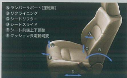
8WAYマルチアジャスタブルパワーシート (フロントシート/クッション長電動可変機構・メモリー付[運転席])
