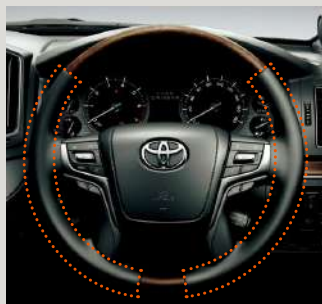
ヒーター 加温箇所
