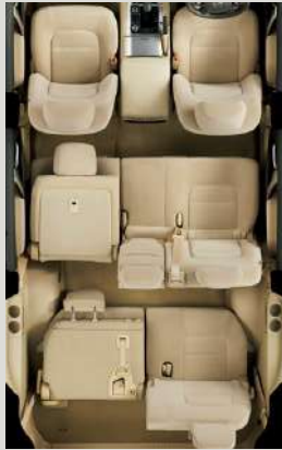
セカンドシートバック左側前倒し+サードシートバック左側前倒し状態
